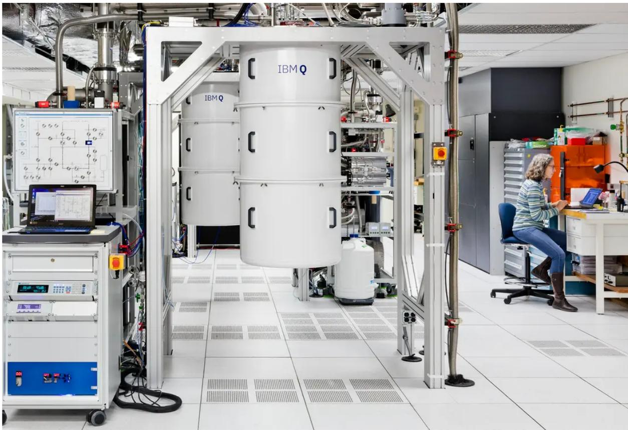
Supraleitende Qubits arbeiten nur bei sehr tiefen Temperaturen. Die weißen Zylinder enthalten deshalb mehrstufige Kühlmaschinen, die im Innersten den eigentlichen Quantenprozessor bergen.
